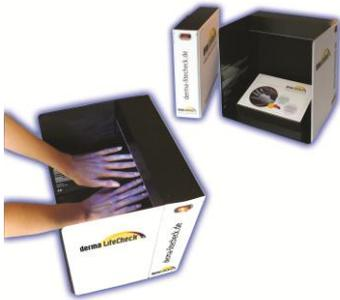
Für den Fluoreszenztest wird eine mit einem Fluoreszenzmarker versehene Testlotion benötigt. Betrachtet man die mit der Testlotion eingecremten Hände in der Dermalux-Checkbox, so erscheinen die behandelten Hautpartien weiß und heben sich kontrastreich von den Stellen ab, die beim Eincremen nicht ausreichend behandelt wurden, z.B. die Fingerzwischenräume.
